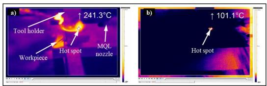
Figure 5. Cutting temperature results at the infrared thermal camera, a) MQL cutting condition, b) LN<sub>2</sub> cutting condition (Kızılötesi termal kamerada kesme sıcaklığı sonuçları, a) MQL kesme koşulu, b) LN<sub>2</sub> kesme koşulu)
