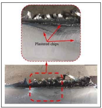
Figure 3. Plastered chips under LN<sub>2</sub> cutting condition (LN<sub>2</sub> kesme koşulunda talaş sıvanması)
